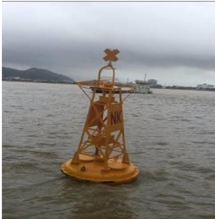
Hình 3.60. Minh họa thiết lập báo hiệu hàng hải chuyên dùng khu vực thi công
